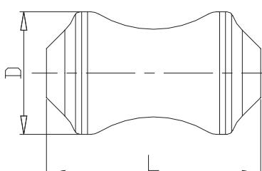
**SMV Zylindermolch aus Silikon** **SMV silicone cylinder pig**
