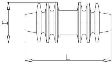
**SMV Lamellenmolch aus Silikon** **SMV silicone lamellar pig**
