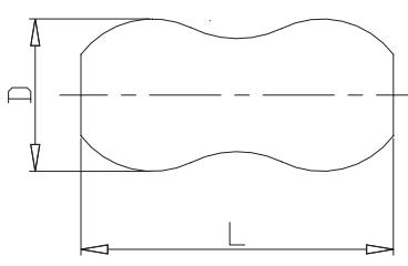
**SMV Sphäromolch aus Silikon** **SMV silicone sphere pig**
