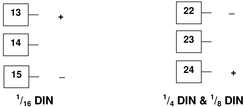
Figure 27. Option Slot 2 - Linear Voltage & mADC module
