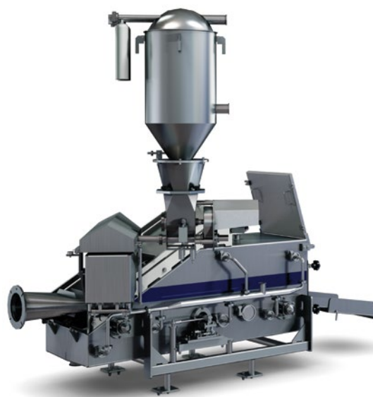
Fig. 16.30 Dry salter for pasta filata.
